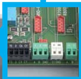
Borniers colorés et séparés pour faciliter les branchements et le diagnostic
