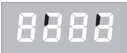
Les vantaux sont en cours d'ouverture, l'afficheur est le suivant :
