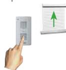
2. Pour tous les volets sur une période plus longue, positionner le bouton de l'horloge sur «0». Le pilotage des volets est désactivé au plus tard le lendemain matin (les volets ne se lèveront plus en mode automatique).
