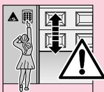
Les appareils de commande fixes (p. ex. boutons-poussoirs), doivent être installés en vue de la porte, mais à l'écart des pièces mobiles et à une hauteur de minimum 1,5 m. Ils doivent absolument être installés hors de portée des enfants!
