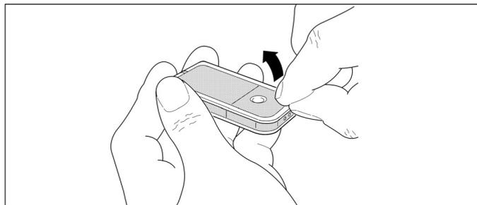
02. En maintenant le cadre soulevé, pousser d'un doigt le couvercle de la pile, comme l'indique la figure ci-après.
