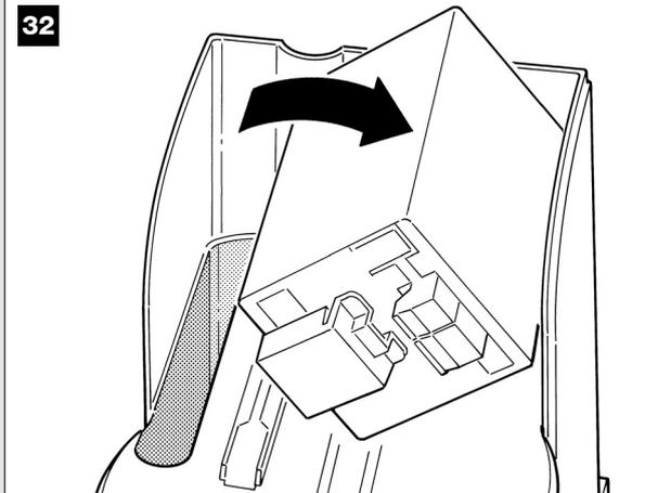
03. Fig. 33 : après avoir effectué le travail, remettre la logique de commande dans son logement de la façon suivante :
