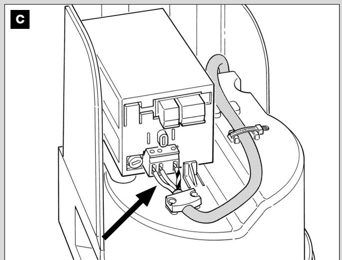
**03.** Pour finir, remettre le serre-câble et le couvercle du bornier et refermer l'opérateur avec son couvercle.
