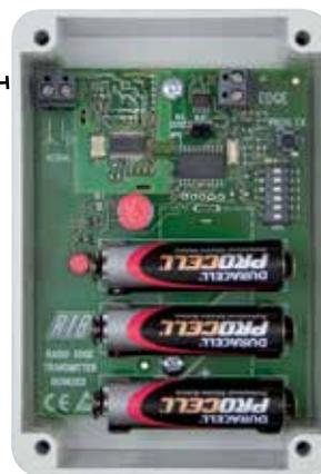
ACG6202 ÉMETTEUR RADIO RED pour capteur sur porte sectionnelle avec accès piétons. À alimenter avec 3 piles bâton de type AA de 1,5V non incluses
