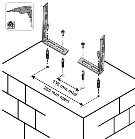
**⚠ Le côté le plus court de l'équerre doit être vissé sur le pilier/mur.**
