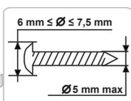
[1]. Positionner le gabarit (13) fourni dans le pack contre le pilier/mur. Percer 4 trous.
