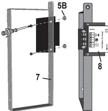
Visser le contrôleur de charge (8) sur la bride (7) en introduisant les vis (5B) par dessous et en positionnant les écrous (5B) sur le dessus du contrôleur.
